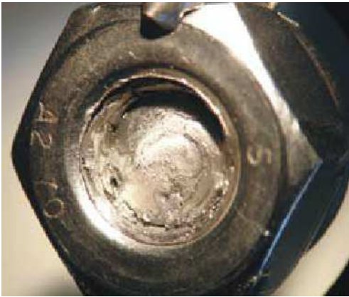
Fig. 4 Run out thread of screw / Vida dişinin çürümesi
