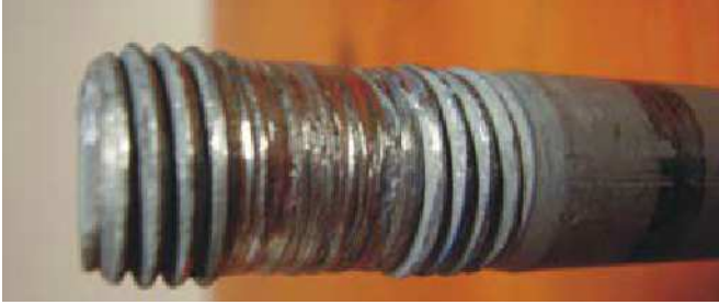
Fig. 4 Run out thread of screw / Vida dişinin çürümesi
