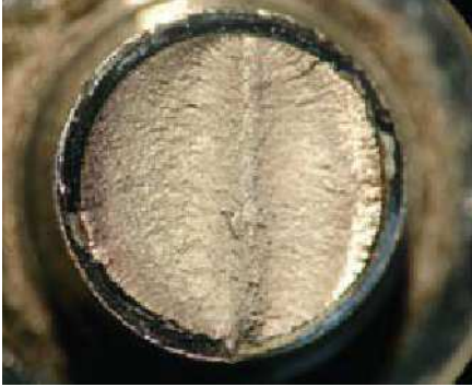
Fig. 8 Fracture surfaces after bilateral loading / çift taraflı yükleme sonrası çatlak yüzeyleri
